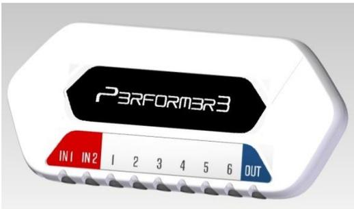
**IN1 / IN2:** conexiones para las sondas de entrada del paciente (integradas en el conjunto de tubos desechables)
